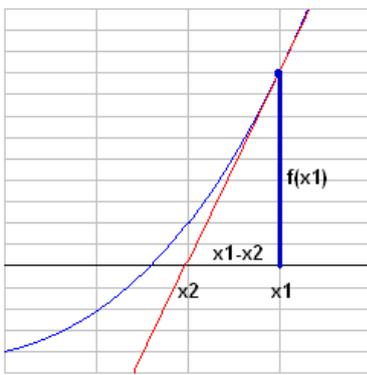
Die Methode beim Newtonverfahren ist nun folgende: man sucht sich eine Näherung  $x_1$  der Nullstelle und berechnet damit  $f(x_1)$  und  $f'(x_1)$ . Mit Hilfe der Tangente in  $(x_1, f(x_1))$  sucht man den Schnittpunkt der Tangente mit der x-Achse auf und hat eine neue Näherung der Nullstelle, diesmal näher.
